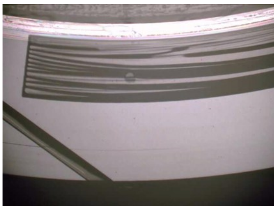
e) Time : 600sec, Cavitation pressure:92kPa(abs.)
