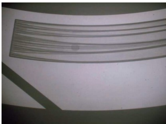
e) Time : 600sec, Cavitation pressure:68kPa(abs.)
