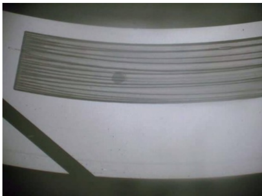
e) Time : 600sec, Cavitation pressure : 69kPa(abs.)
