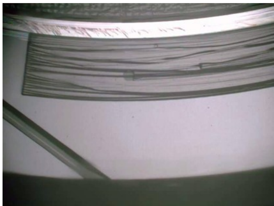
e) Time : 600sec, Cavitation pressure:88kPa(abs.)
