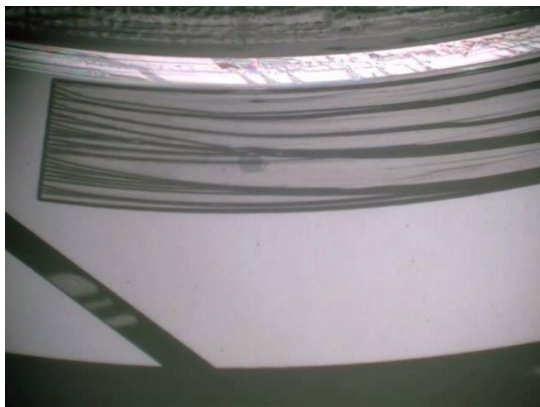
e) Time : 600sec, Cavitation pressure:77kPa(abs.)
