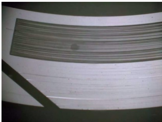
e) Time : 600sec, Cavitation pressure : 43kPa(abs.)
