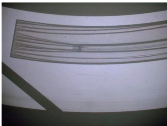
e) Time : 600sec, Cavitation pressure : 69kPa(abs.)
