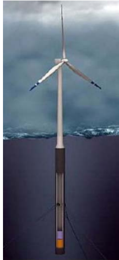
図 2-1. Hywind project にて実証された 2.3MW 浮体式洋上風力発電システム
