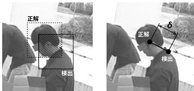
図 24 物体検出における精度(適合率)と物体追跡における精度
