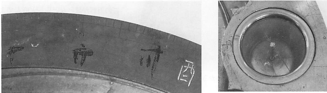
図4. 佐賀器目盛環の墨書（左）と、エンジンバラ器の磁針（右）
