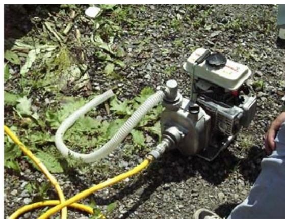
図 1-9 自給式エンジンポンプを用いた浮遊砂観測手法 9)
