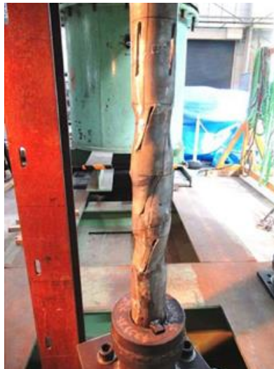
写真-4.3 ねじり抵抗試験状況 (その2)
