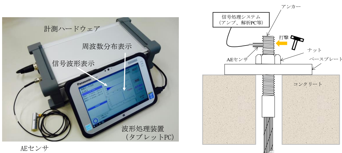
図-3.1 AEセンサを用いた計測・診断概要
