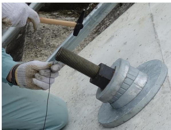
写真-3.1 AEセンサを用いた計測状況
