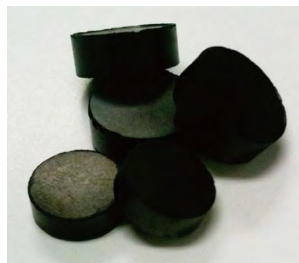
図6. 褐炭の熱間成型・炭化法によって調製した高強度コークス
