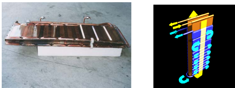
図 4.2.4 最終試作機の給湯熱交換器の概観と構成図
