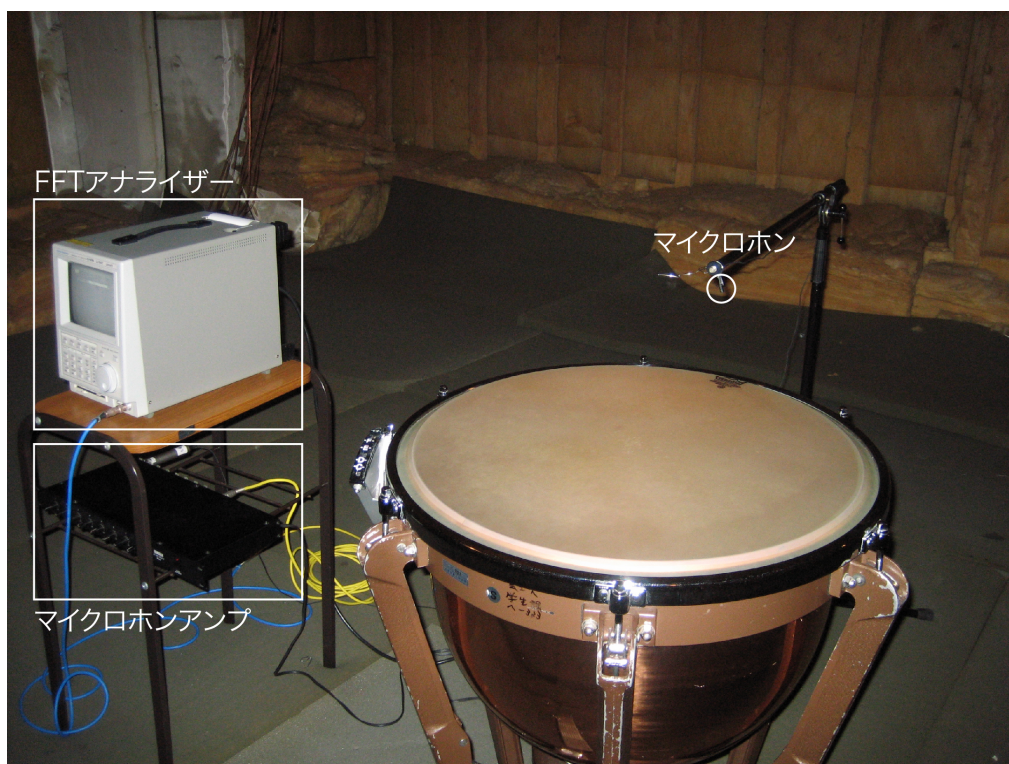
図 3.5: 測定に使用したティンパニと機材
