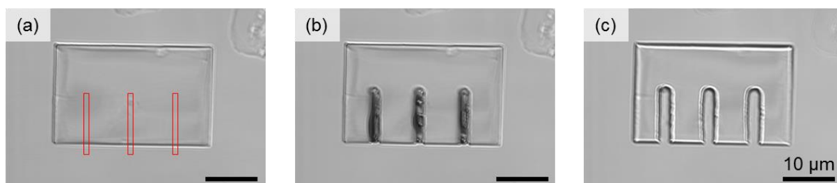
図 5-23. 水中でのレーザー照射過程における (1)_2\text{H}[\text{PMo}_{12}\text{O}_{40}] シートの LSM 像. (a) レーザー照射前, (b) 照射直後, (c) 10 分後.
