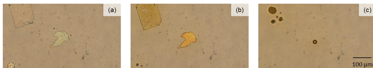
図 4-9. (a) UV 光 (365 nm) 照射前, (b) 5 秒照射後, (c) 15 秒照射後における trans -AP-1 結晶の光学顕微鏡像。
