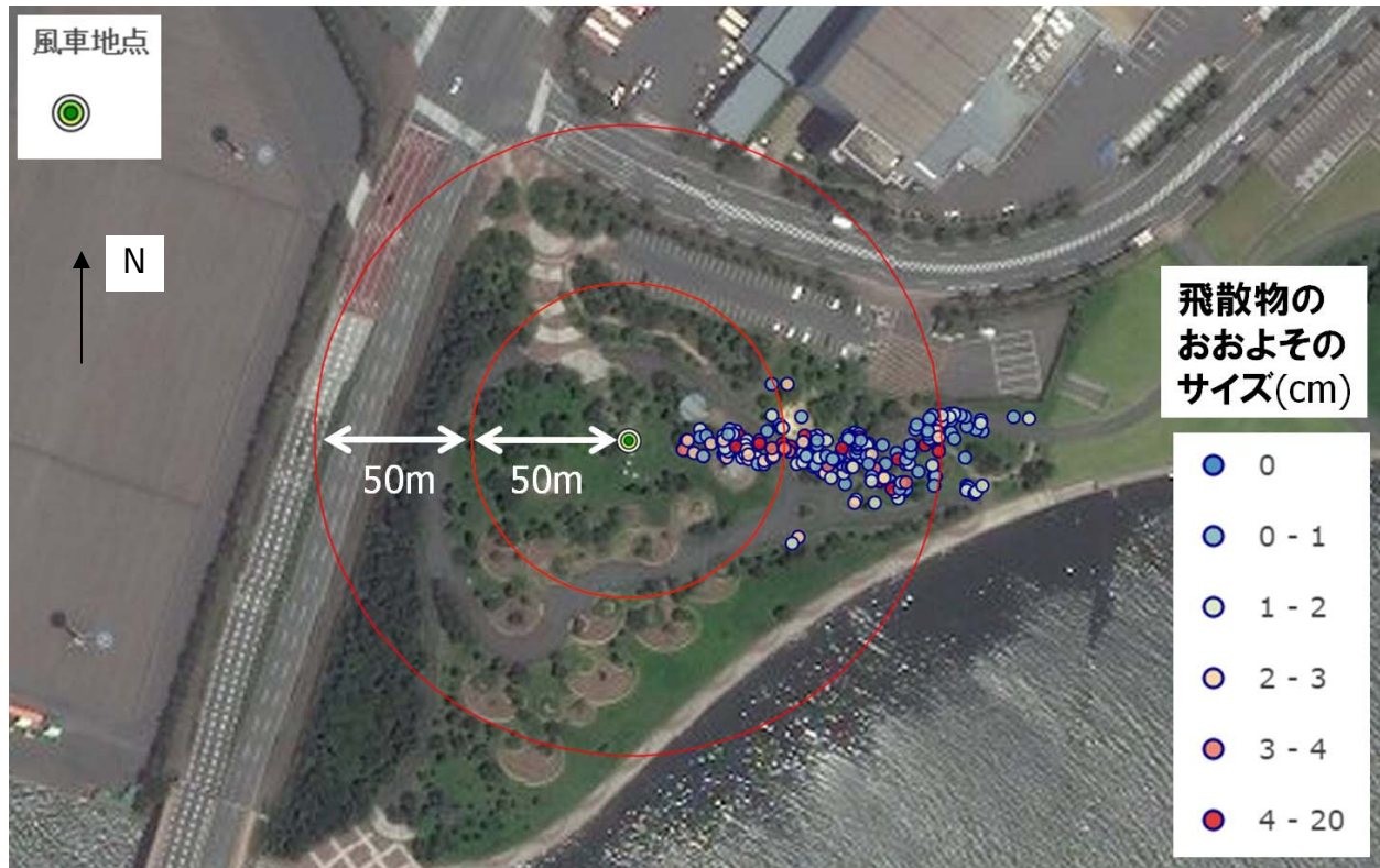
図3 風車の飛散物を地図上にプロットした様子
