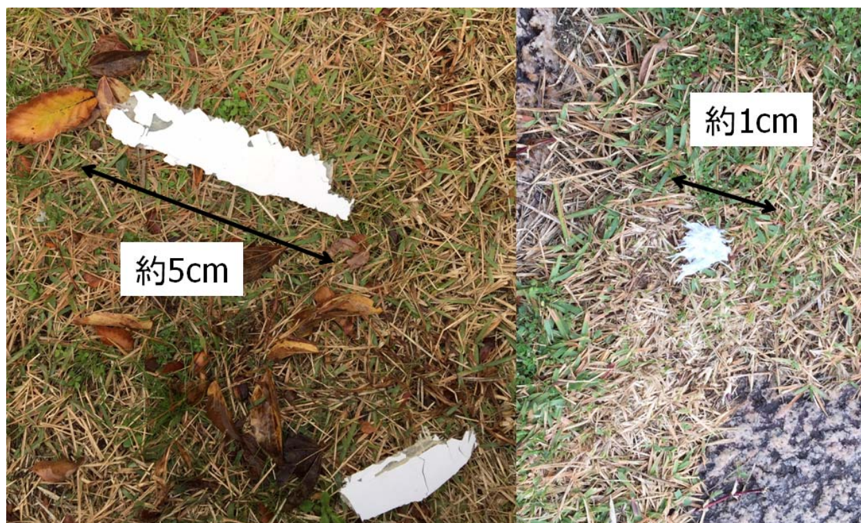
図2 著者が2014年12月3日に撮影した飛散物(風車ブレード等の破片)の様子
