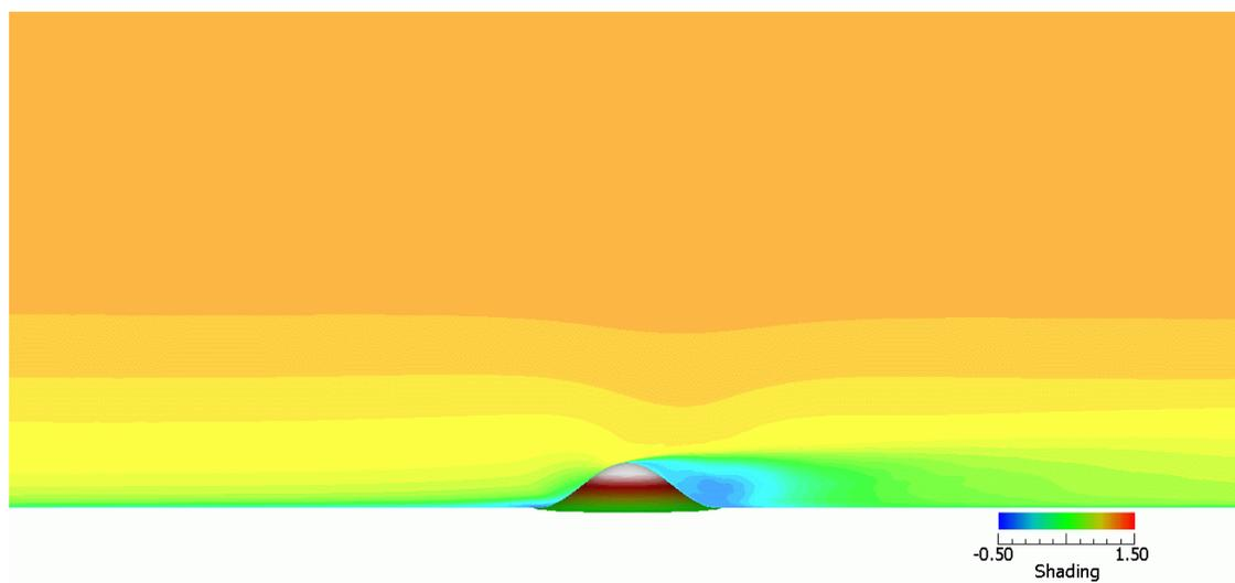
(b)中立時,  $Ri = 0$
