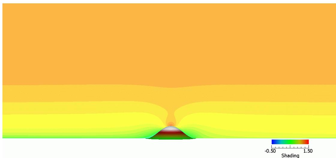
(c)安定時,  $Ri = +1$ 図4 スパン中央面における主流方向の速度成分の分布, 時間平均場(フレーム平均場),  $Re = 10^4$
