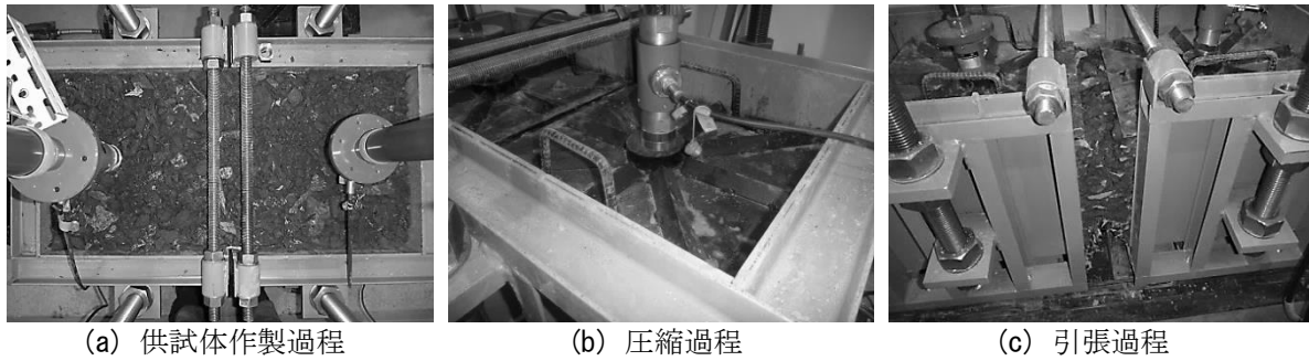
図-5.11 大型引張試験の工程とその様子
